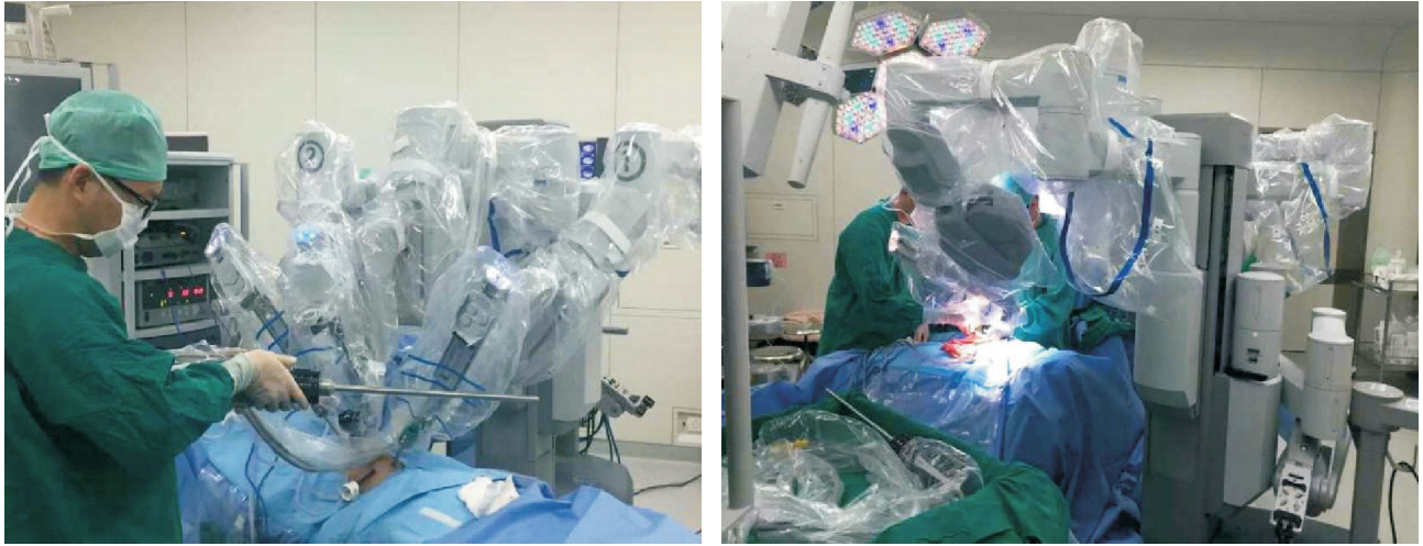
图1 链接达芬奇系统(Docking)建立无菌屏障
